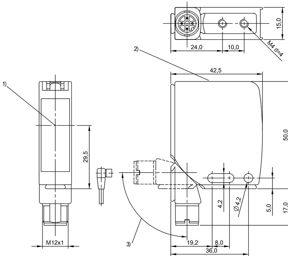
1) Eje óptico, 2) Panel de indicación y control, 3) Girable 270°
